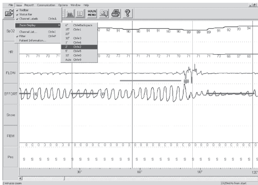
Figura 3. Registro de poligrafía en página de 2 minutos. Se detalla la posibilidad de cambiar la ventana de tiempo para la lectura. Se evidencian en este trazado eventos de flujo (Flow) con esfuerzo torácico (Effort) y desaturaciones, por fenómenos de apneas obstructivas.
